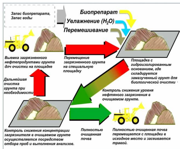
Рисунок 2 - Технология очистки грунта на рекультивационных площадках
